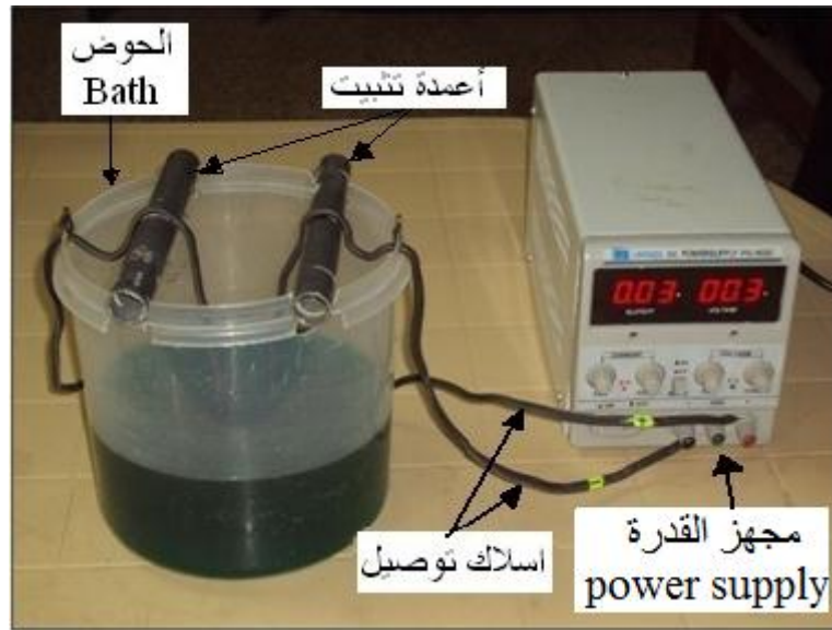
شكل (3): اجزاء منظومة الطلاء الكهربائي
