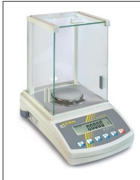
شكل (10): ميزان حساس لقياس الكتلة
