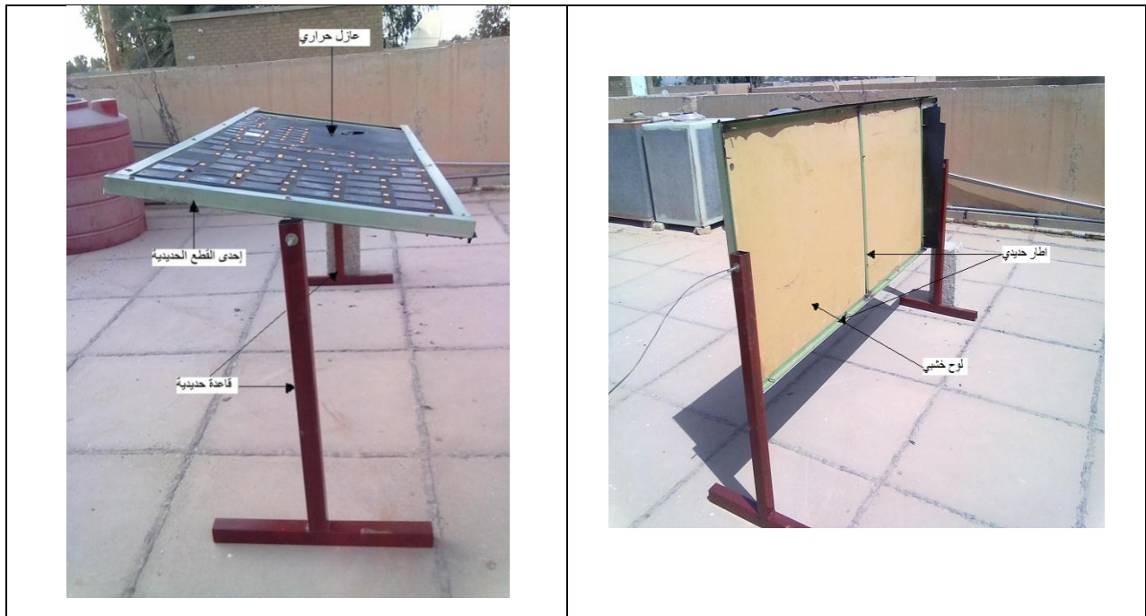
شكل (6): منظومة اختبار اداء العينات
