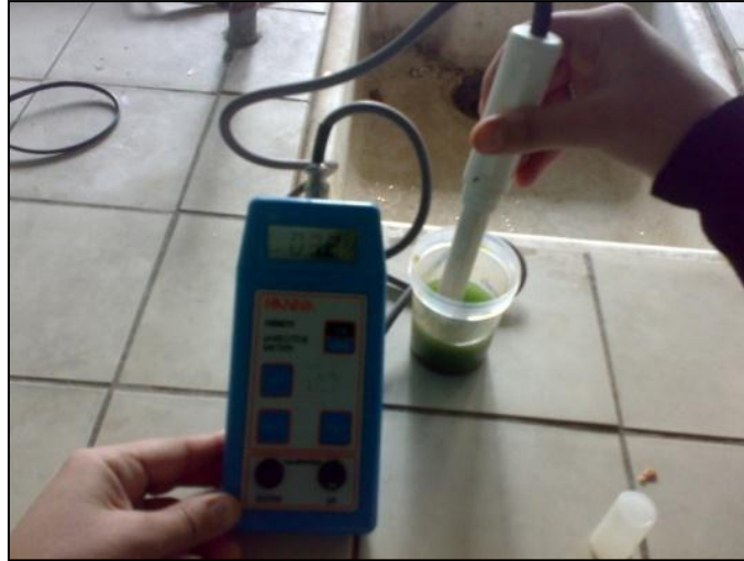
شكل (9): جهاز قياس الحامضية (ph meter)
